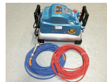
コンプレッサー 高圧用ホース (赤) 低圧用ホース (青)
