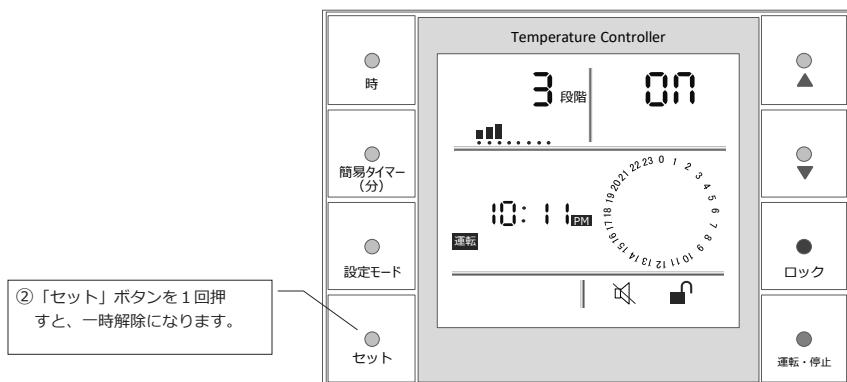
上の図は1時解除で稼働している場合の表示です。時刻表示の左下には「運転」の文字が表示されます。
