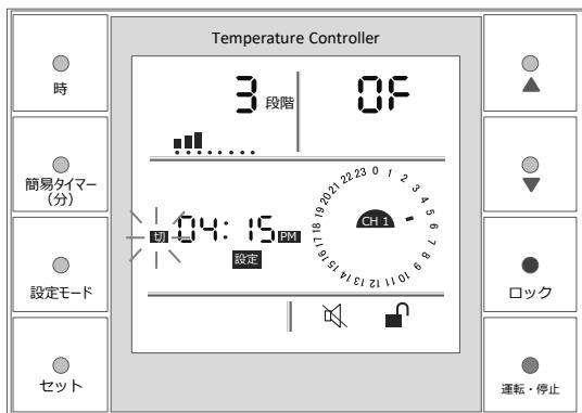
上の図は稼働を終了する時間を入力した状態です。この後で、「セット」ボタンで稼働終了時間を確定します。
