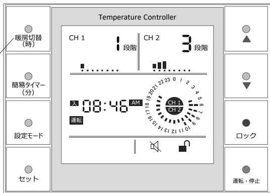
左図は独立暖房で、1チャンネルをレベル1で予約タイマーを5時から20時（夜8時）まで設定して、2チャンネルはレベル3で予約タイマーを6時から10時まで設定して、稼働させている状態です。
