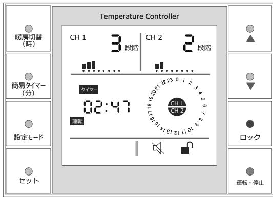
左図は独立暖房運転で簡易タイマーを設定しており、残り2時間47分で電源が切れる状態を表しています。
