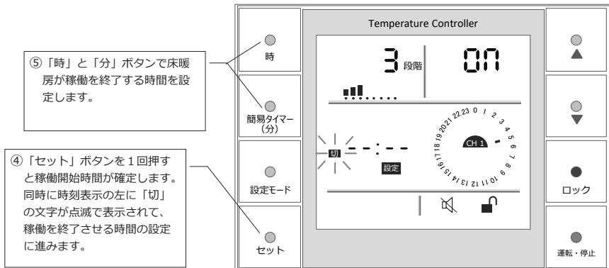
上の図は床暖房が稼働する時間が確定して、稼働を終了する時間を設定する直前の状態です。
