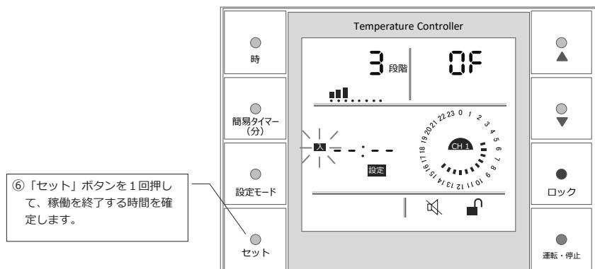
上の図は稼働を終了する時間が確定して、次の稼働時間帯の設定ができる状態になっている状態です。予約タイマー表示エリアには稼働する時間帯がグラフで表示されます。
