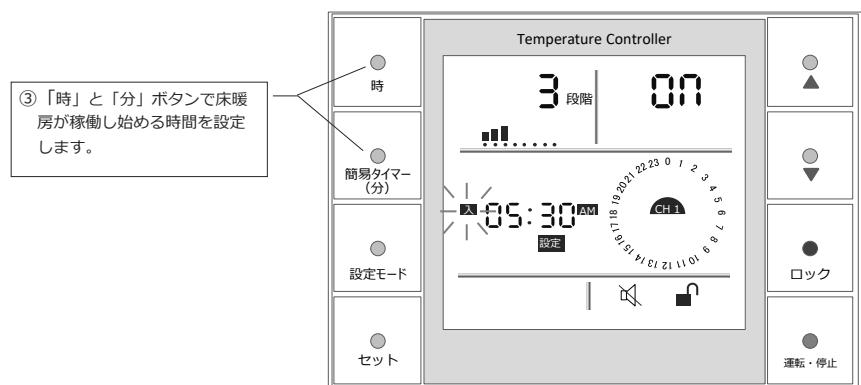
上の図は床暖房が稼働する時間を入力した状態です。朝5時30分から床暖房が稼働する設定です。
