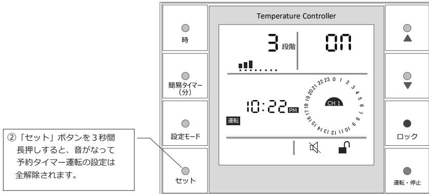
上の図は全解除して通常運転をしている場合の表示です。時刻表示の左下には「運転」の文字が表示されます。「通電表示エリア」はON・OFFを繰り返します。「予約タイマー表示エリア」は時間帯の表示が消えますが真ん中の「CH-1」は表示されます（一時解除は「CH-1」が表示されません）。
