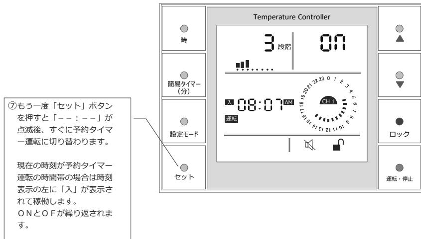
上の図は予約タイマー時間帯でのディスプレイ表示です。ONとOFが切り替わりながら稼働します。予約タイマーはコントローラーの電源が入っている状態でしか機能しません。電源が切れた状態か予約タイマー稼働開始時間に電源が自動で入るものではありません。
