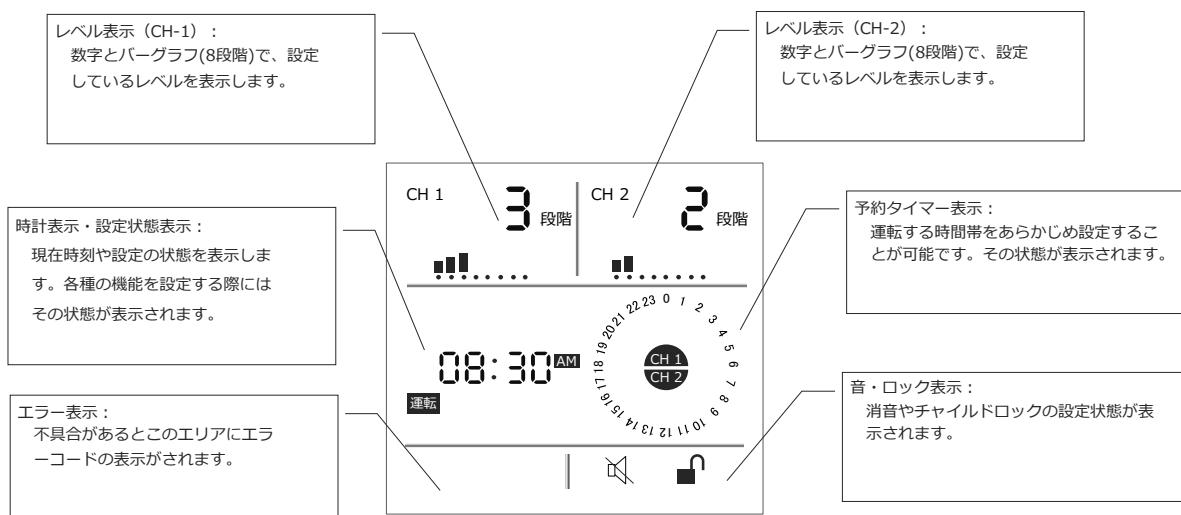
上図はCH-1をレベル3でCH-2をレベル2で通常運転している状態を表示しています。
