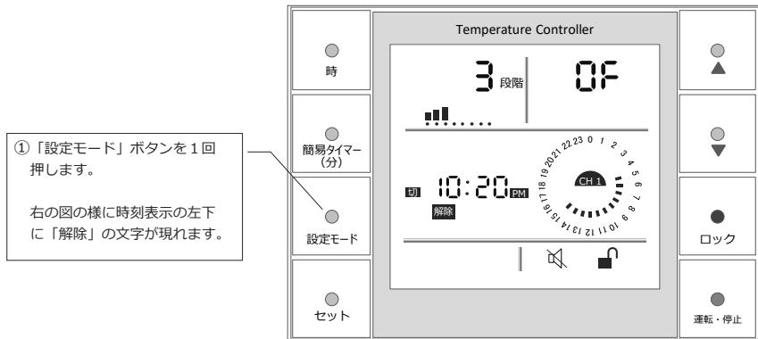
上の図は予約タイマー運転の時間帯以外で運転している場合を表しています。AM 5:30～PM 4:15で予約タイマー運転が設定されており、上図はPM 10:20（22:20）で時間帯以外ですので、時刻表示の左には「切」が表示されています。通電表示エリアもONが表示されています。
